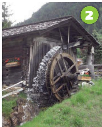
Un bacino di acqua posto ad una certa altezza (1) dispone di **energia potenziale**, se l'acqua inizia a scorrere per gravità nell'alveo di un torrente o a precipitare sotto forma di cascata, l'energia potenziale si trasforma in **energia cinetica**. Su questa proprietà dell'acqua di possedere un'energia trasformabile in un'altra, si basa il funzionamento delle ruote dei mulini ad acqua (2) che trasformano l'ener-
