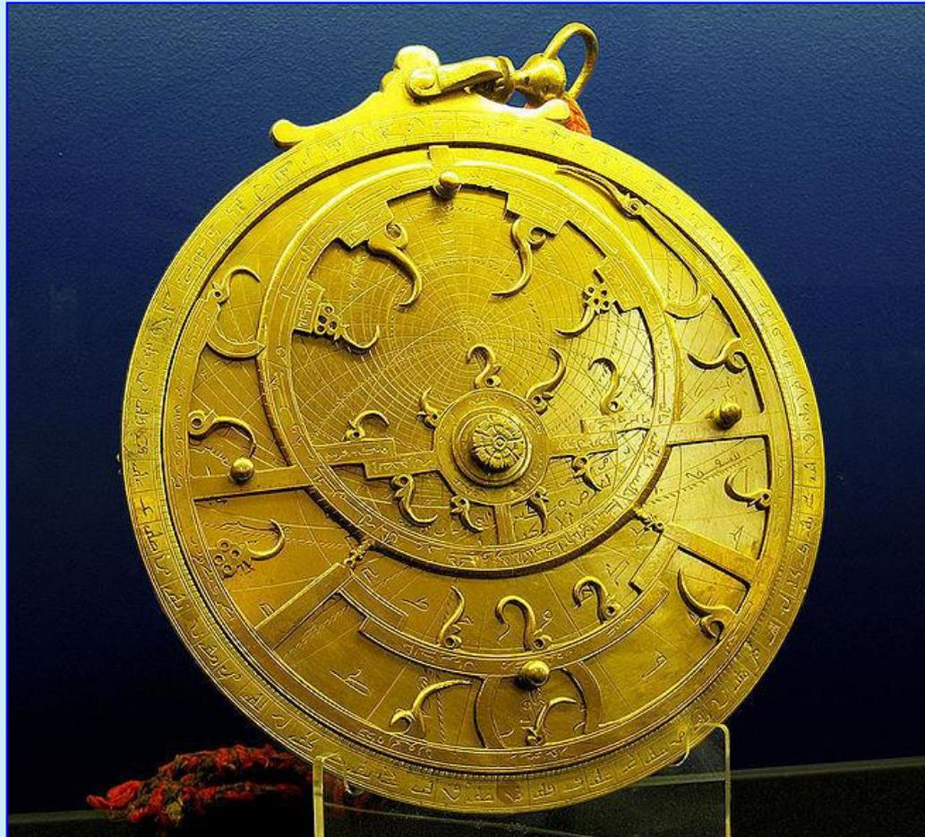
**L'astrolabio** è uno strumento di navigazione tramite il quale è possibile localizzare o predire la posizione di corpi celesti come il Sole, la Luna, i pianeti e le stelle
